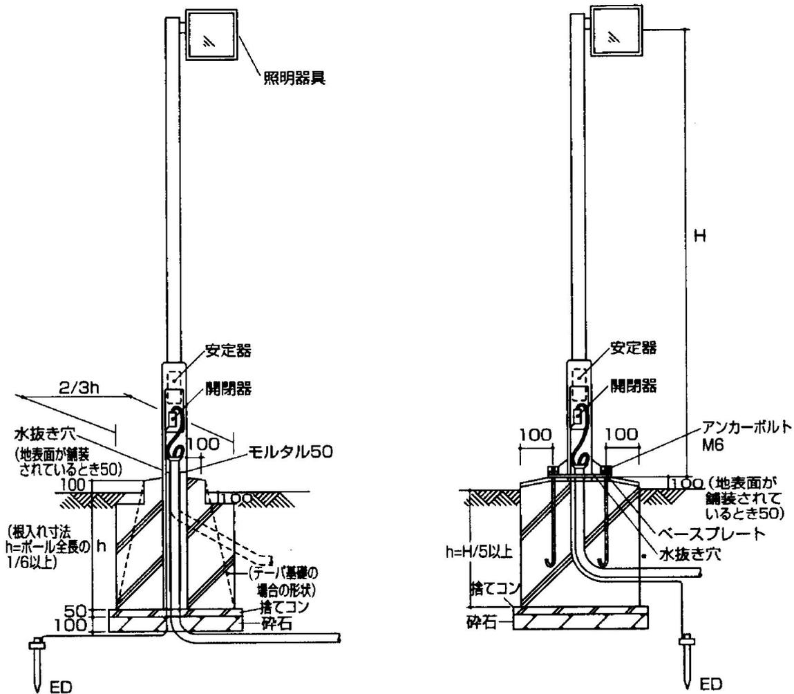
配管は地中埋設管を使用する。(CD管不可)
